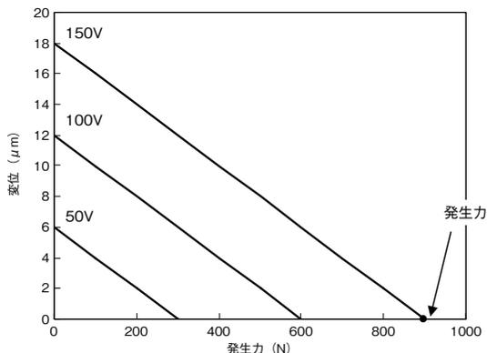
図2 AE0505D16の発生力例 (印加電圧別)
