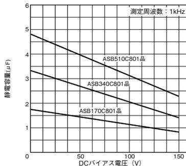
図14 DCバイアス電圧 vs. 静電容量
